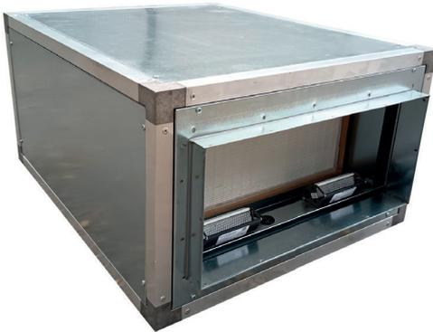
Unidades de filtración absoluta para conducto, con ventilador Plug Fan EC de alta eficiencia, periferia de aluminio anodizado con tapas en acero galvanizado con aislamiento termo acústico de 15 mm de espesor con prefiltro F7 y filtro HEPA H14 de alta capacidad de filtración.
