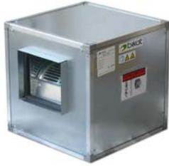
Unidades de ventilación para conductos, con ventilador centrífugo con motor incorporado de rotor externo (RE) ultrasilencioso, periferia de aluminio, aislamiento termo acústico de 15 mm de espesor y tapas intercambiables. Caudales disponibles desde 1.440 m<sup>3</sup>/h hasta 11.650 m<sup>3</sup>/h.
