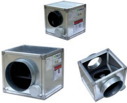
Unidades de ventilación para conductos, con ventilador centrífugo tipo EC con motor incorporado de rotor externo (RE) ultrasilencioso, periferia de aluminio, aislamiento termo acústico de 15 mm de espesor y tapas intercambiables. Caudales disponibles desde 660 m<sup>3</sup>/h hasta 1.430 m<sup>3</sup>/h.
