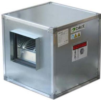
Unidades de ventilación para conductos, con ventilador centrífugo con motor incorporado, perfiles de aluminio, aislamiento termoacústico de 15 mm de espesor y tapas intercambiables. Caudales disponibles desde 1.080 m<sup>3</sup>/h hasta 9.100 m<sup>3</sup>/h.
