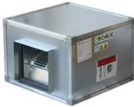
Unidades de ventilación de baja silueta (BS) para conductos, con ventilador centrífugo con motor incorporado, periferia de aluminio, aislamiento termo acústico de 15 mm de espesor y tapas intercambiables.
