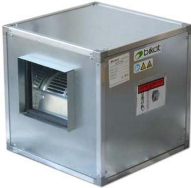
Unidades de ventilación con ventilador centrífugo con motor EC de alta eficiencia incorporado, perfiles de aluminio, aislamiento termoacústico de 15mm de espesor y tapas intercambiables. Caudales disponibles desde 2.340 m<sup>3</sup>/h hasta 7.040 m<sup>3</sup>/h.
