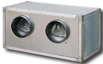
Unidades de ventilación para conductos, con dos ventiladores centrífugos en paralelo con motor incorporado de rotor externo (RE) ultrasilencioso, perifería de aluminio, aislamiento termoacústico de 15 mm de espesor. Caudales disponibles desde 1.820 m³/h hasta 2.860 m³/h.
